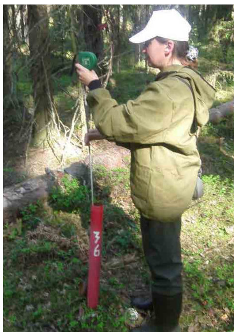
Замер уровня грунтовых вод
